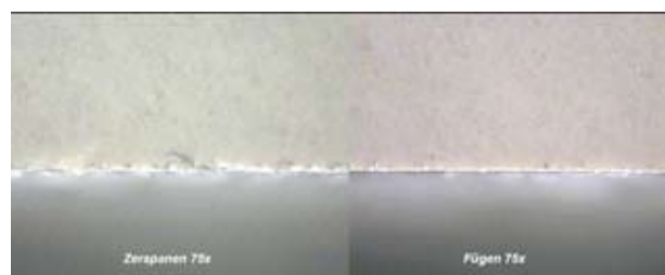
Schnittkantenvergleich: Zerspanen - Fügen
